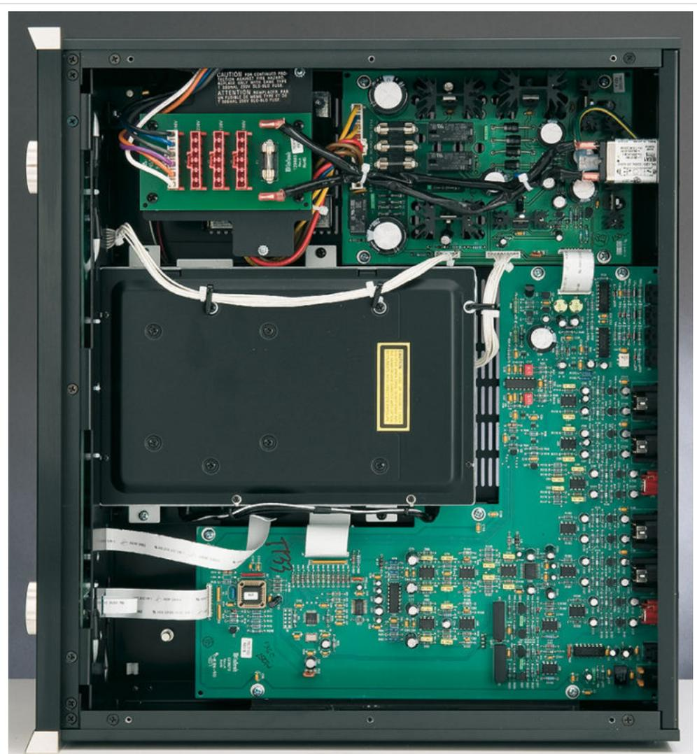
Un grande stampato per i circuiti analogici e di controllo, ma che ospita anche il DAC, una meccanica dall'aspetto robusto assieme a una sezione di alimentazione: l'MCD301 è tutto qui, ma è molto ordinato e realizzato a mestiere. Com'è tradizione per il marchio americano.
