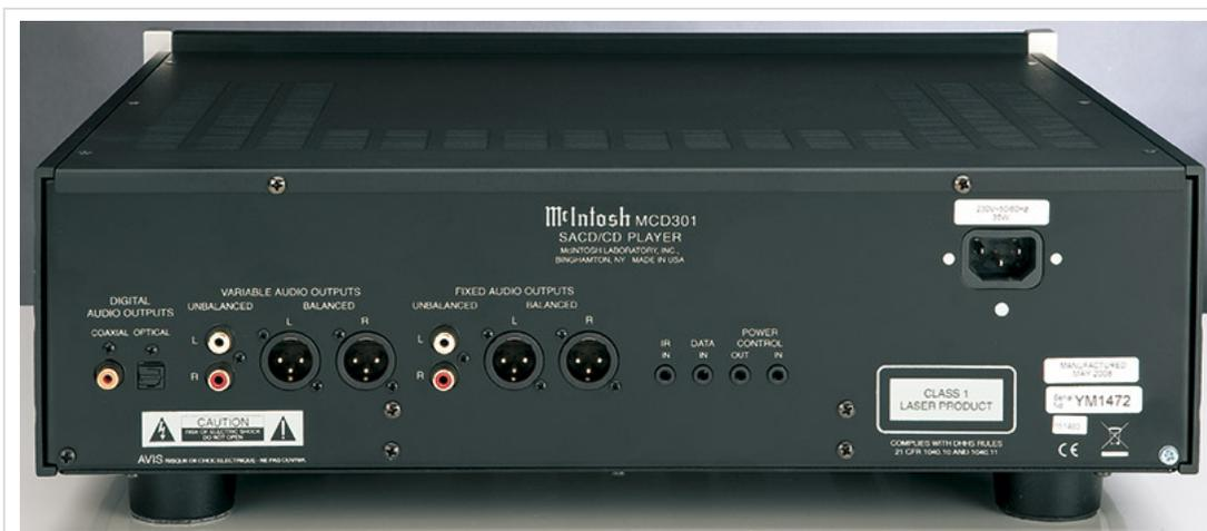
Inusuale per un lettore di dischi ottici la dotazione di prese: il fatto è che l'MCD301 dispone di un regolatore di volume interno e pertanto è stato dotato di uscite a livello sia fisso che regolabile. Ciascuno dei due tipi, poi, è presente in formato single-ended e bilanciato.
